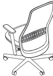
Die höhenverstellbare Lordosstütze gibt dem Rücken im Bereich der Lendenwirbelsäule zusätzlichen Halt, ohne spürbaren Druck auszuüben.
