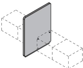
Ossature en bois rembourrée d'une mousse en polyuréthane. Socle en bois massif laqué noir. S'installe toujours entre deux banquettes. Liaison par connecteur fixe sur les faces frontales des banquettes. Combiné au paravent, un module d'électrification ne peut être installé que sur l'une des faces du paravent.
