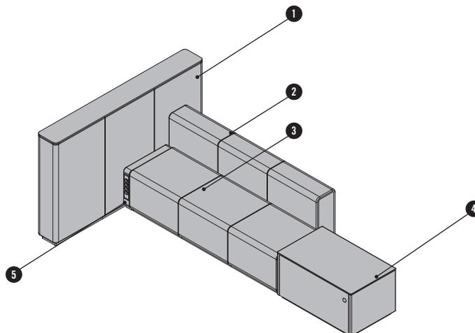
Tous les éléments rembourrés de Causeway disposent d'une ossature en bois. Les éléments d'assise sont revêtus d'une mousse indéformable en polyuréthane. En option, version ignifuge conforme à la norme BS 5852 partie 2, source d'allumage 5 (Crib 5). Tapissage avec doubles surpiqûres.
