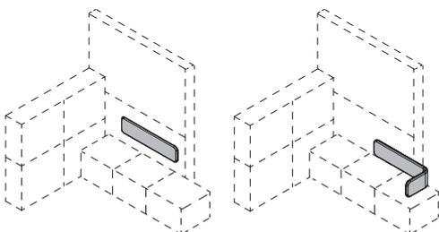
Les dossiers sont disponibles droits ou en angle, dans différentes dimensions. L'élément structurel est un plateau en bois préformé, rembourré d'une mousse indéformable en polyuréthane.
