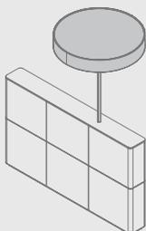
Ne peut être fixé que sur une cloisonnette haute. L'abat-jour en circumference est revêtu de tissu ou de cuir. Le pied du lampadaire fait 30 mm de diamètre et en AL aluminium thermolaqué. L'abat-jour dispose d'un diffuseur en plexiglas en PW blanc satiné en haut et en bas. Éclairage composé de 8 bandes LED (3000 K) disposées en cercle. Elles s'allument par un interrupteur à tirette.
