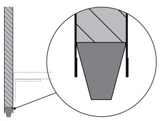
Panneau de fibres de bois de 40 mm, recouvert d'un revêtement en tissu, fermé en bas par une fermeture velcro
