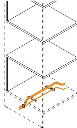
Kabelführung mit Kabelklemmwinkel unterhalb des untersten Bodens. Möglich über einzelne Module oder über das ganze Panel Rack. Die Durchverkabelung erfolgt durch Öffnungen in den Mittelseiten.
