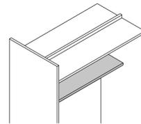
Ein 50H hohes Panel Rack mit durchgehender Rückwand ist immer mit einer Ablage ausgestattet welches in der Tiefe auf 250 mm verkürzt ist.
