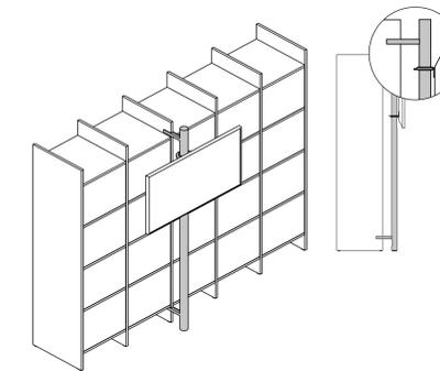
Die Screenanbindung erfolgt wahlweise vorne oder hinten an eine Mittelseite oder Abdeckseite des Panel Racks, mittels Befestigungsklemmen. Die Höhe der Screenhalterung ist fix vordefiniert und erlaubt eine leichte seitliche Drehbewegung.
