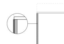
Die Rückwand kann optional als pinnbare Stoffrückwand konfiguriert werden. Der Aufbau besteht aus einer 16 mm Spanplatte + 3 mm MDF-Platte + 5 mm Weichfaserplatte + Stoff nach Wahl je Herstellerkollektion.
