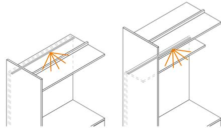
Eine LED-Beleuchtung ist mit einer durchgehenden Rückwand immer möglich. Diese wird an der Unterseite des oberen Fachbodens angebracht, oder an der Unterseite der Ablage, immer in voller Modulbreite.
