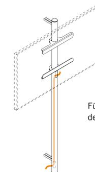
Für die Verkabelung des Screens werden Kabel durch Öffnungen im Rohr der Screenanbindung geführt.
