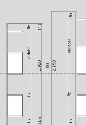
Die unteren beiden Nischen sind immer gleich hoch, unabhängig von der Gesamthöhe des Panel Racks. Erst ab der dritten Nische ändert sich die Höhe und wird gleichmäßig auf die verbleibenden Nischen aufgeteilt.
