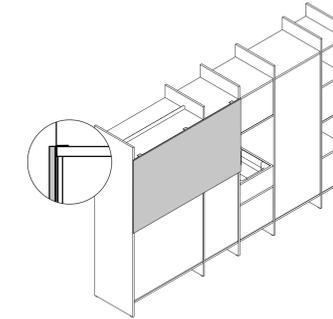
Das Whiteboard kann an das Panel Rack mittels Metallwinkeln angebunden werden.
