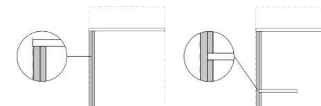
Die Nische im unteren Bereich ist immer mit einer Rückwand ausgestattet. Die optional durchgehende Rückwand ist ab Nische drei immer gedoppelt.
