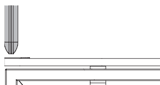
T-Panel Curve monté dans la découpe du plateau (un cache en matière plastique pour la découpe du plateau n'est pas disponible)
